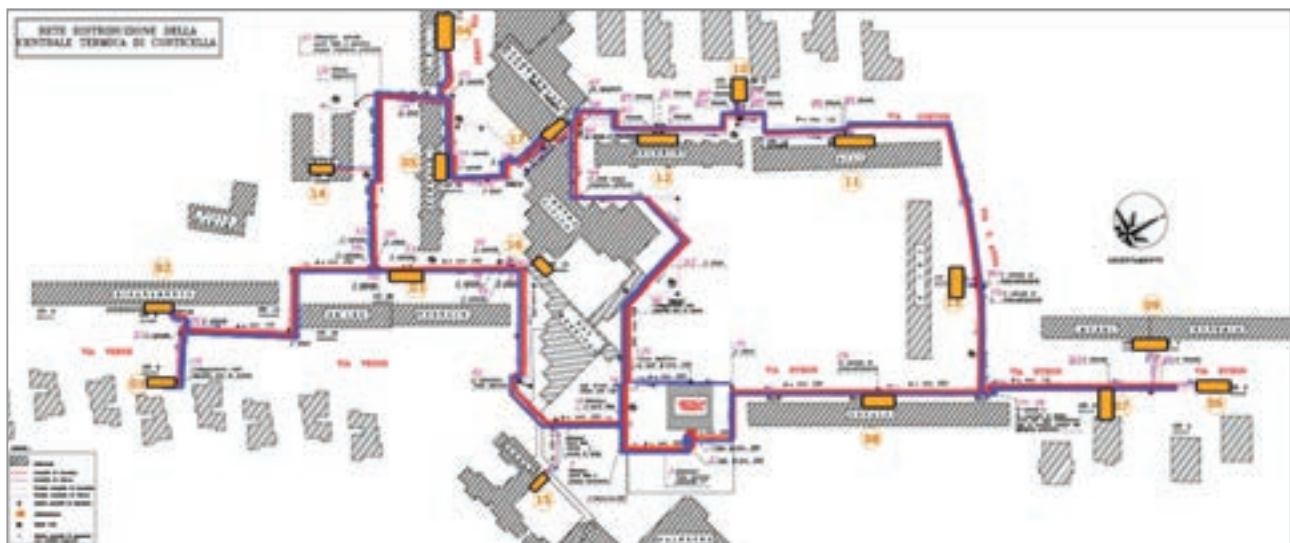
Figura 2 - Rete di teleriscaldamento del quartiere PEEP Corticella
